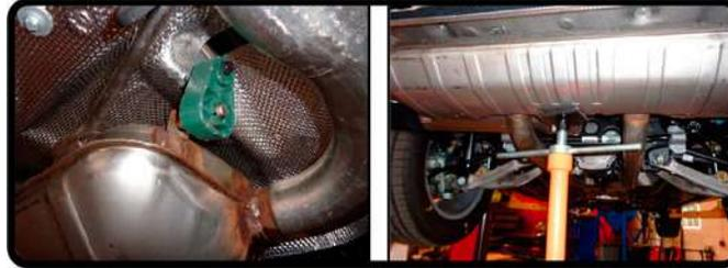
**2.** Bajar el exosto para facilitar el montaje y el aislante térmico. Retire el empaque de goma (uno de cada lado) del gancho en el vehículo. Soporte el exosto para evitar daños.
