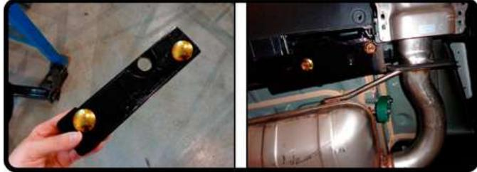
**7.** Ubicar las platinas de ajuste (**Item D y E**) y pasar los tornillos de carriage a través de los orificios de la platina. Coloque el conjunto de las platinas sobre las pestañas del travesaño del bomper y alinee con los agujeros en el tiro de arrastre. Asegure usando las tuercas.
