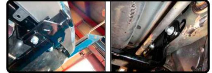
**9.** Levante el receptor del tiro de arrastre y fije a la platina en L (según imagen) con los tornillos de carriage (**Item J**).
