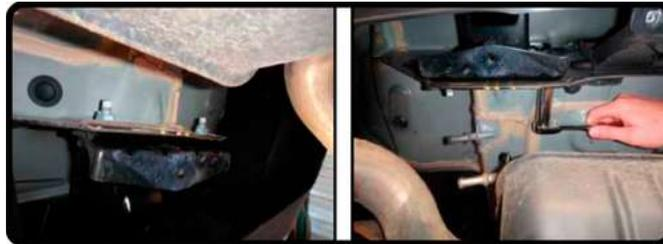
**5.** Retire las tuercas inferiores (2) que aseguran el alma bomper al vehículo en ambos lados. Debe guardarlos para volver a armar.
