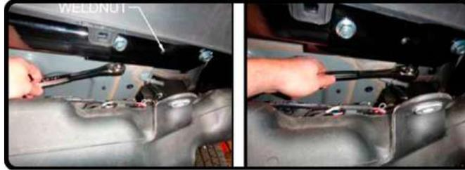
**8.** Centre los orificios del tiro de arrastre con las tuercas que se encuentran soldadas a la viga del bomper y asegure con tuercas. Apriete todos los tornillos en X. Levante y asegure el exosto.
