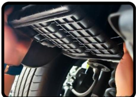
**1.** Desenganchar el exosto y bajar la pila del carro.
